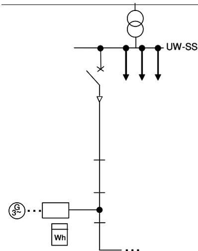
**Bild C.1** Netzanschlusspunkt im Mittelspannungsnetz
