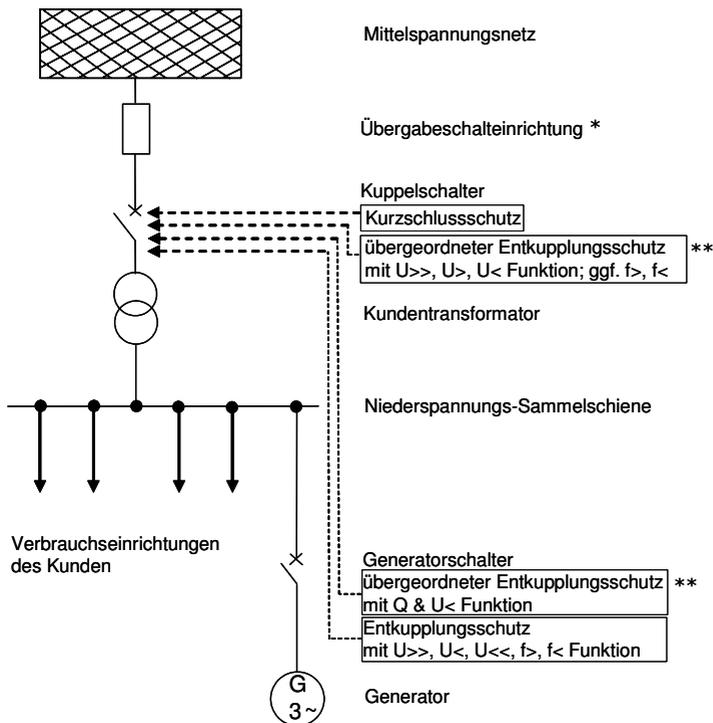
**Bild C.8:** An das Mittelspannungsnetz angeschlossene Kundenanlage mit Erzeugungseinheit mit einer Erzeugungseinheit und Inselbetriebsmöglichkeit über mittelspannungsseitigen Kuppelschalter
