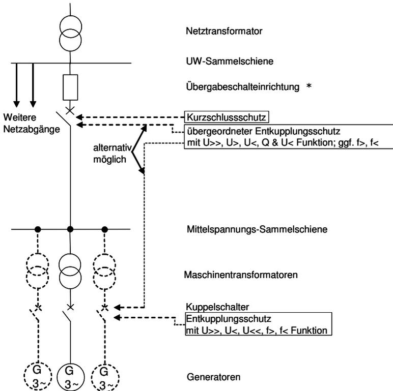
**Bild C.10:** An die Mittlungs-Sammelschiene eines Umspannwerkes angeschlossene Erzeugungsanlage mit einer oder mehreren Erzeugungseinheiten ohne Inselbetriebsmöglichkeit
