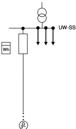
**Bild C.2** Netzanschlusspunkt an der Mittelspannungs-Sammelschiene eines Umspannwerkes
