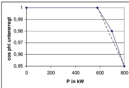
Bild D.1-1:  $\cos\varphi(P)$ -Kennlinie
