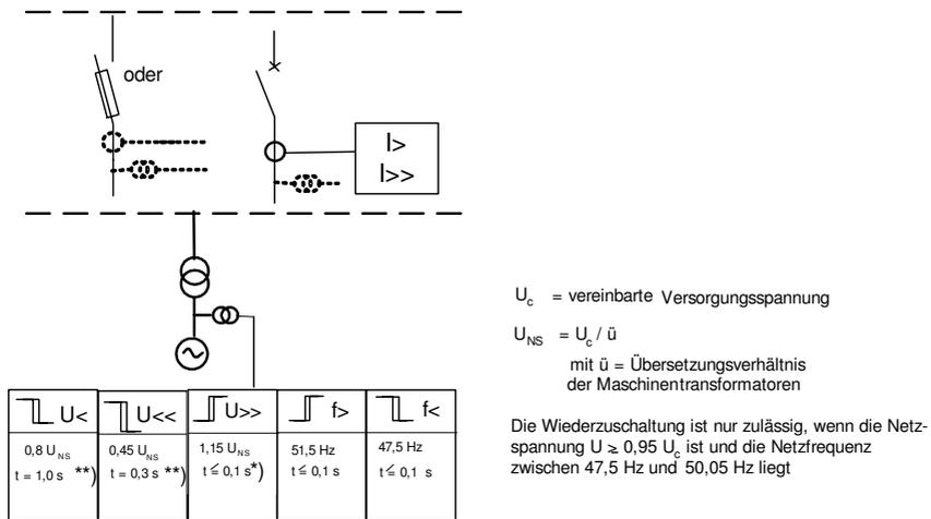
**Bild 3.2.3.4-1:** Schutzkonzept bei Anschluss von Erzeugungsanlagen im Mittelspannungsnetz
