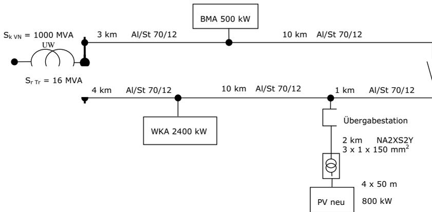
Kurzschlussleistung des vorgelagerten Netzes:  $S_{kVN} = 1000 \text{ MVA}$
