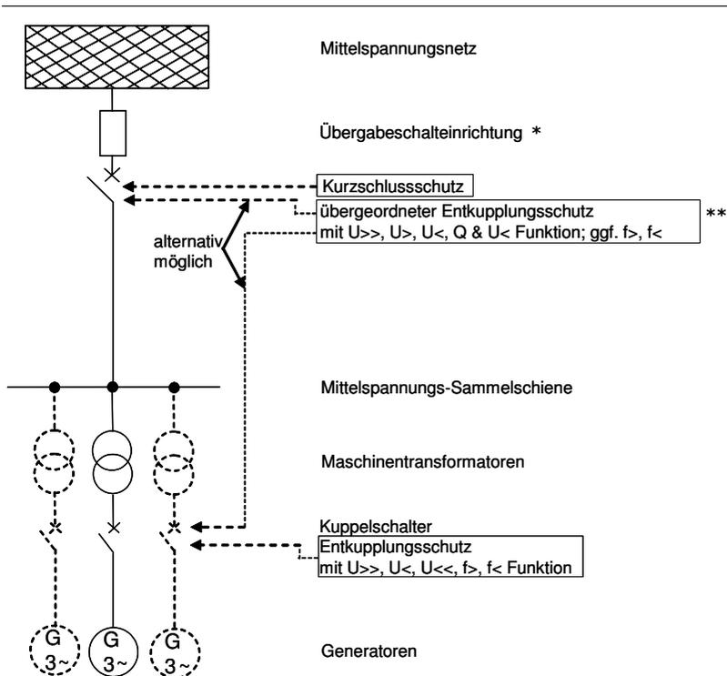
**Bild C.9:** An das Mittelspannungsnetz angeschlossene Erzeugungsanlage mit Leistungsschalter und einer oder mehreren Erzeugungseinheiten ohne Inselbetriebsmöglichkeit
