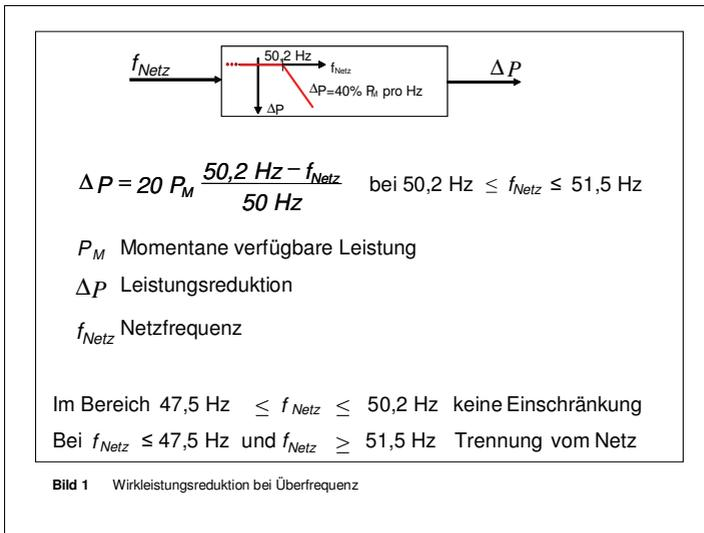
**Bild 2.5.3-1:** Wirkleistungsreduktion bei Überfrequenz (aus TransmissionCode 2007)
